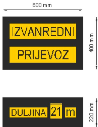
2. Skica vozila pratrje opremljenog žutim rotirajućim svjetlom i osvijetljenom pločom s natpisom »Izvanredni prijevoz« s prednje i stražnje strane.
